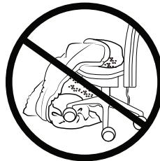
En raison de ses composants électroniques, le contrôleur peut légèrement chauffer lorsque la couverture électrique fonctionne. Ne recouvrez donc jamais le contrôleur et ne le placez pas sur des sources de chaleur lorsqu'il fonctionne.
