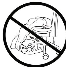
Die elektronischen Bauteile des Reglers können dazu führen, dass er sich beim Verwenden die Heizdecke leicht erwärmt. Der Regler darf daher während des Betriebs niemals auf oder unter Wärmequellen abgelegt werden.
