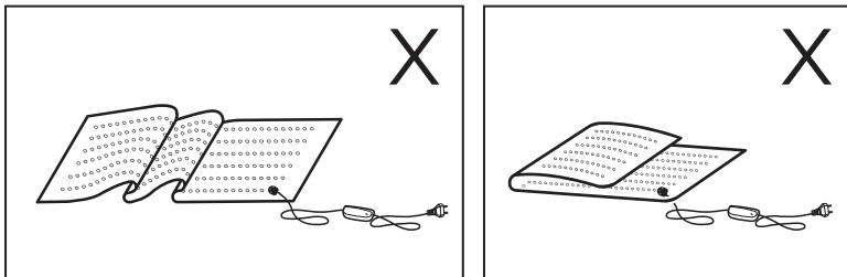
N'utilisez pas la couverture si la couverture ou le cordon d'alimentation risquent d'être coincés ou pliés, par exemple sur un lit réglable, un canapé-lit ou un fauteuil de bureau à roulettes.
