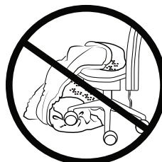
De elektronische onderdelen in de schakelaar kunnen warm worden als de deken aan staat. Daarom dient de schakelaar niet afgedekt te worden of geplaatst te worden bovenop een in gebruik zijnde andere verwarmingsbron.
