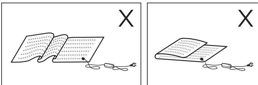
Verwenden Sie die Heizdecke nicht, wenn die Heizdecke oder das Stromkabel leicht eingeklemmt oder geknickt werden kann, zum Beispiel auf einem verstellbaren Bett, einer Schlafcouch oder einen Bürostuhl mit Rädern.
